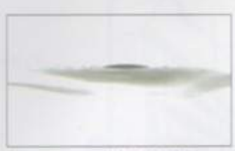
ピュアコートAN-G塗装面接触角:9.7°
